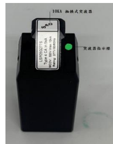
防水型抽換式突波器. 附故障指示燈.
